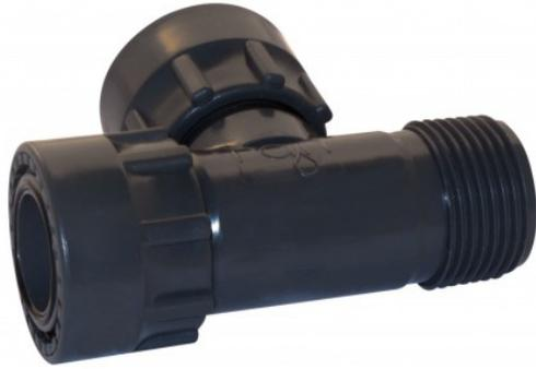
Raccordo Ti Tee in PVC m.f.f diametro 1" con pre-installata guarnizione ad anello O-RING (OR) di tenuta sul filetto. Consente una facile installazione senza l'utilizzo del nastro teflon. Raccordo in PVC altamente resistente. Resistente ai raggi UV - Esente da corrosione e ruggine. Non necessitano di attrezzi per il montaggio né di teflon. Pressione nominale (PN) max 12 bar
